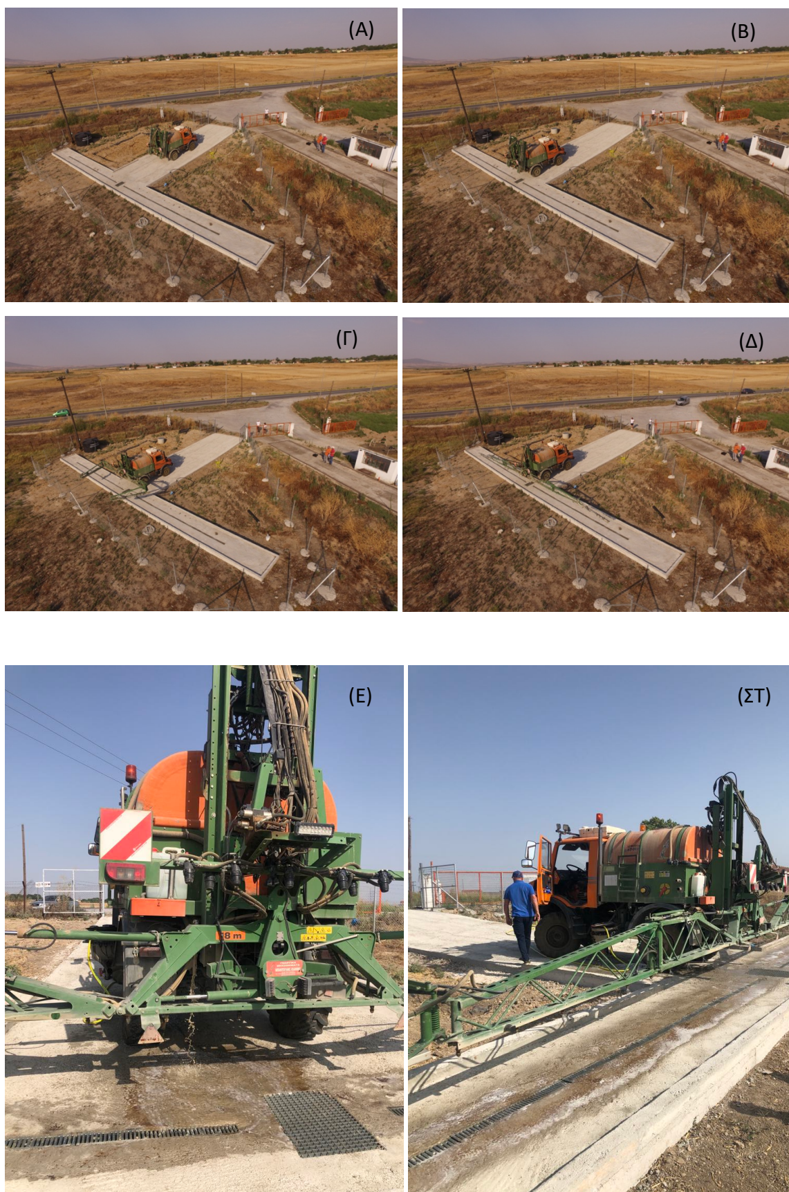
Εικόνα 8. Απεικονίζονται τα στάδια εισαγωγής του γεωργικού ελκυστήρα με το ψεκαστικό μηχανήμα στην βιοκλίνη καθώς και ο τρόπος έκπλυσης τους.
